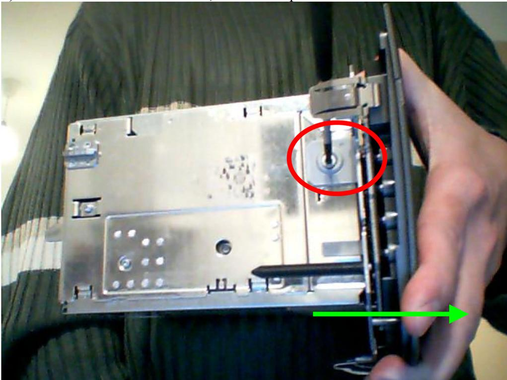
Puis tirer doucement sur la facade, dans le sens de la flèche verte, pour la désolidariser du gros bloc métallique ou y a toute l'électronique dedans.
